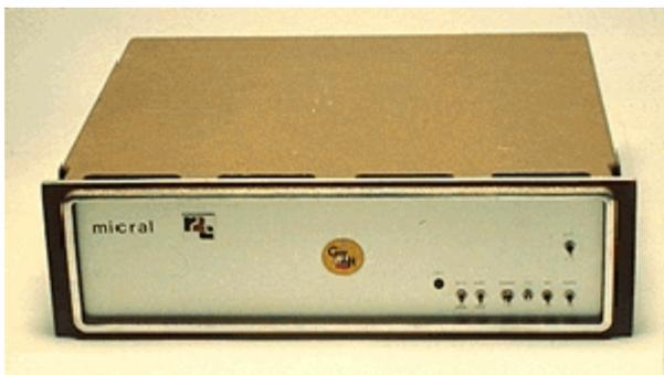
Grosse comme un PC actuel, cette machine ne dispose ni d'afficheur ni de clavier. On se sert d'interrupteurs pour saisir, des diodes affichent le résultat. On peut y connecter un lecteur de bandes perforées. Le Micral fonctionne comme le Kenback-1 américain, ordinateur à circuit intégré vendu en kit dès 71, L'apprentissage est assez simple. 500 Micral sont produits dès la première année, à 8 450 F pièce (1 750 \$), prix étonnant.
